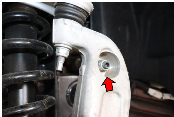
2. Remove 18mm sway bar end link nut.
